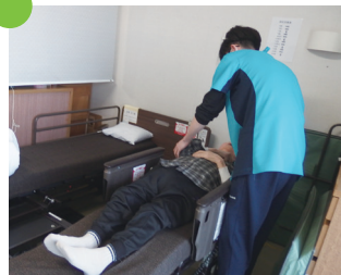
介護ロボット「リショーン」の操作 介護ロボット導入により移乗や移動にかかる介護の負担を軽減。
